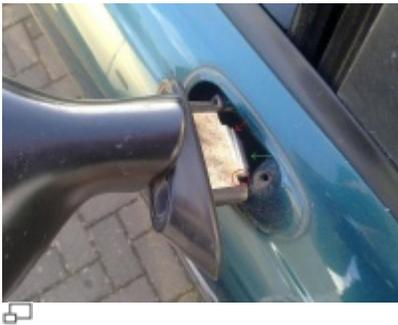
Beim Wiederaufbau darauf achten, dass die Schrauben wieder in genau derselben Position sind wie im Urzustand!
