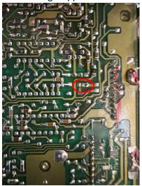
Jetzt Kann amn das Audiosignal anlöten. Links an R341 bzw an C342 und Rechts an R361 bzw an C362. GND einfach an Masse.
