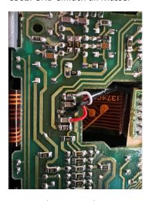
Nun Bracht man noch eine Stromversorgung für das Modul. Diese lässt sich in form von 8V gut am Transistor V2070 gut Abgreifen. Hierzu ist das Pluskabel des Bluetooth Moduls an dem Kollektor jenes Transistors anzulöten. Eine Gute Massestelle für den Minus ist gleich daneben.
