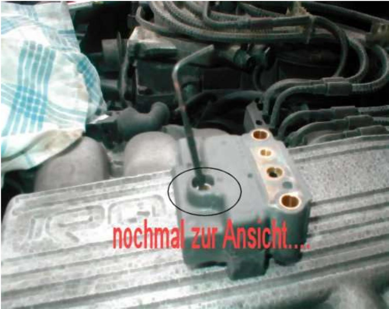
Diese ganze Aktion dient dem anfetten, ältere NG-Motoren neigen zur Erhöhung des Oberkammerdrucks und laufen dadurch zu mager, so reichert ihr das benötigte Benzin wieder an.....und werdet feststellen das der Motor sehr viel agiler zur Sache gehen wird.....
