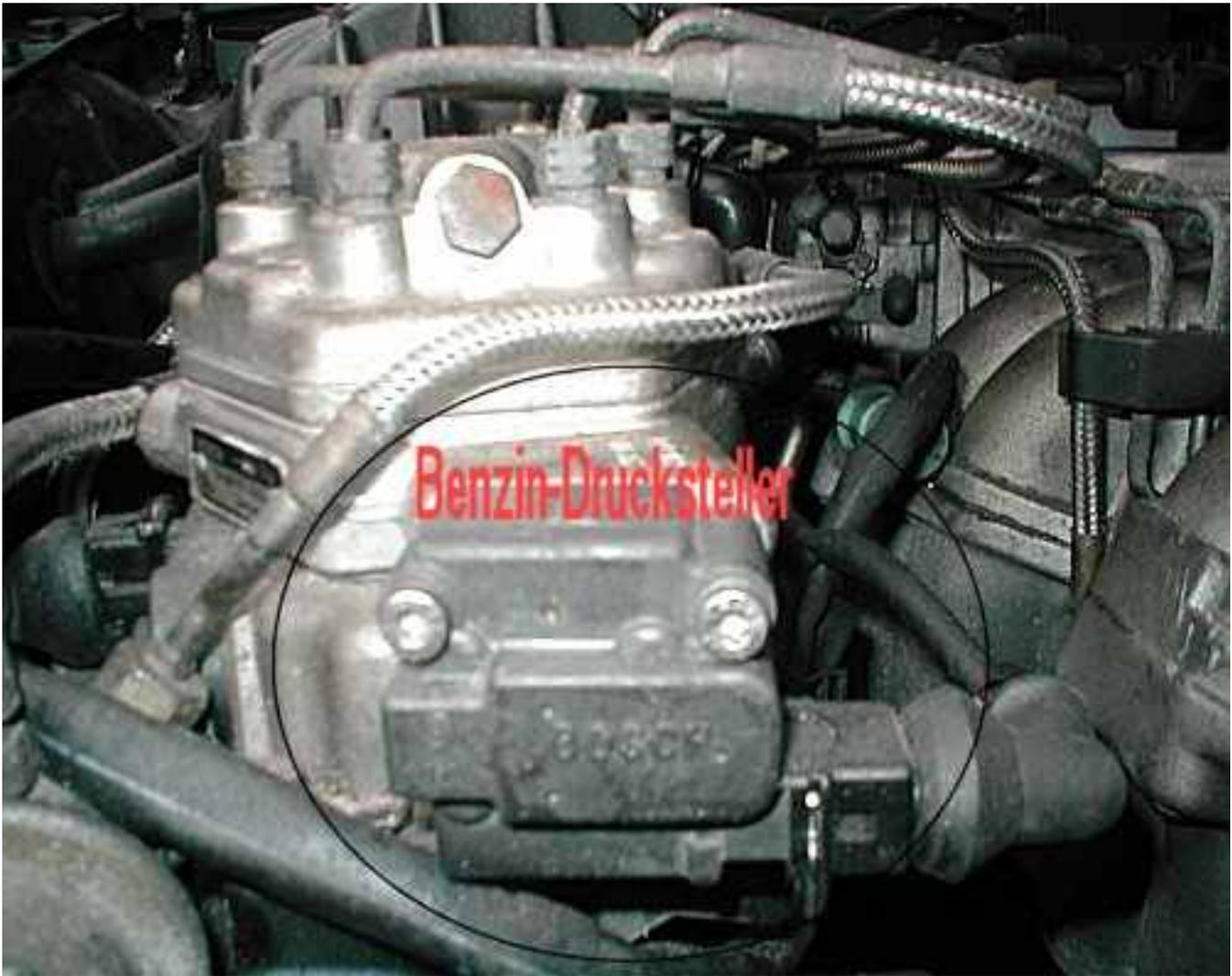
Nun die Schlitzschraube an der Rückseite lösen, darunter befindet sich die Imbusschraube zum verstellen...
