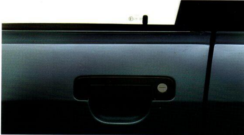
Zentralverriegelung für Türen und Gepäckraum (Serie beim Audi 90). Mehr Komfort und mehr Sicherheit beim Verschließen Ihres Fahrzeuges.
