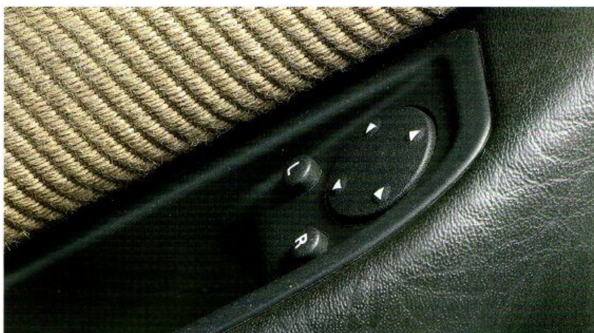
Bedienungselemente für die elektrisch einstell- und beheizbaren Außenspiegel.
