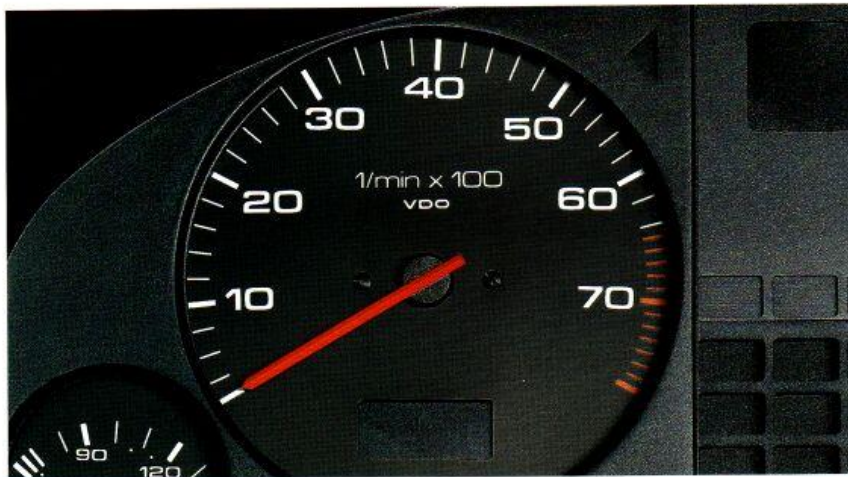
Elektronischer Drehzahlmesser und Zeituhr mit Digitalanzeige für Audi 80 mit 55-kW-Motor.
