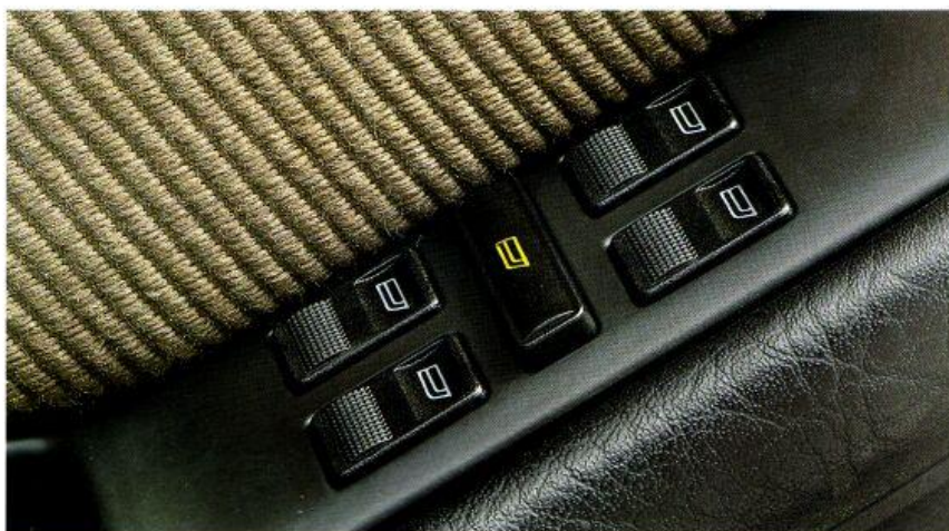
Zentralbedienung für die elektrischen Fensterheber vorn und hinten in der Fahrer-Armlehne.
