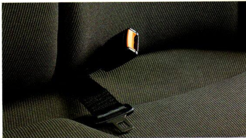
Beckengurt im Fond (Mitte) mit Aufrollmechanismus.
