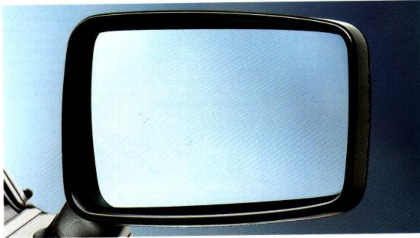
Beheizbare und elektrisch einstellbare Außenspiegel (beim Audi 90 auf der Fahrerseite serienmäßig).
