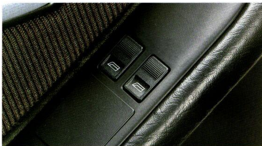
Zentralbedienung für die elektrischen Fensterheber vorn in der Fahrer-Armlehne.
