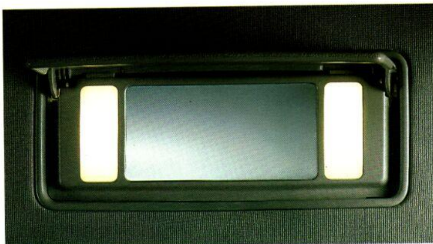
Beleuchteter Make-up-Spiegel in den Sonnenblenden auf der Fahrer- und Beifahrerseite.
