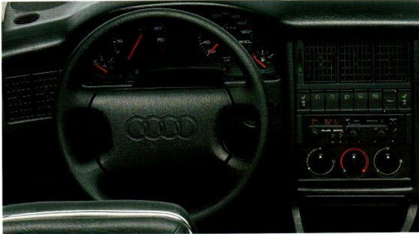
Sportliches Vierspeichen-Sicherheitslenkrad mit lederbezogenem Lenkradkranz.
