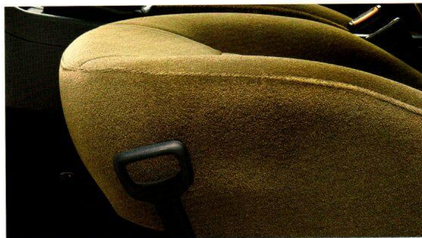
Höheneinstellbarer Fahrer- (bei Audi 90 Serie) und Beifahrersitz .
