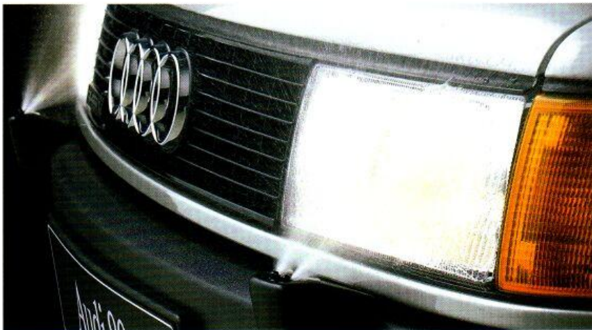
Scheinwerfer-Reinigungsanlage. Schnelle Säuberung der Streuscheiben von Schmutz. Und damit uneingeschränkte Leuchtkraft.
